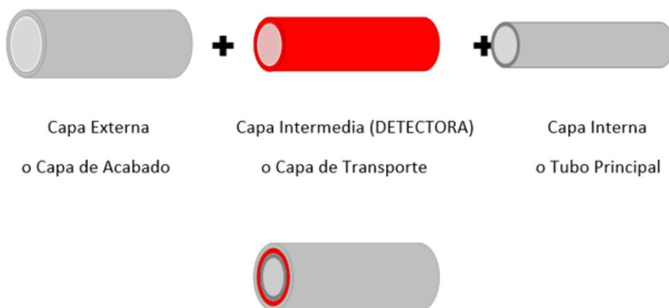
**Figura 17: Esquemas de funcionalidad de cada capa y esquema de configuración del concepto multicapa a medida con capacidad detectora**
