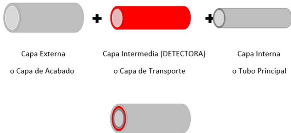
**Figura 10: Esquemas de funcionalidad de cada capa y esquema de configuración del concepto multicapa a medida con capacidad detectora**
